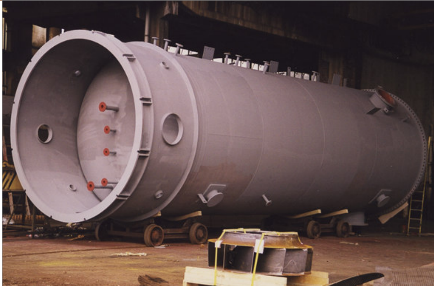
internal heat cured coating Si 14E로 내부 열처리 코팅된 수도관
