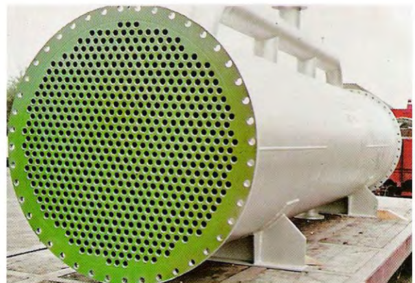
SAEKAPHEN-Si 14 E 로 튜브 측이 코팅된 응축기, 외부에는 아연으로 처리되어 있음
